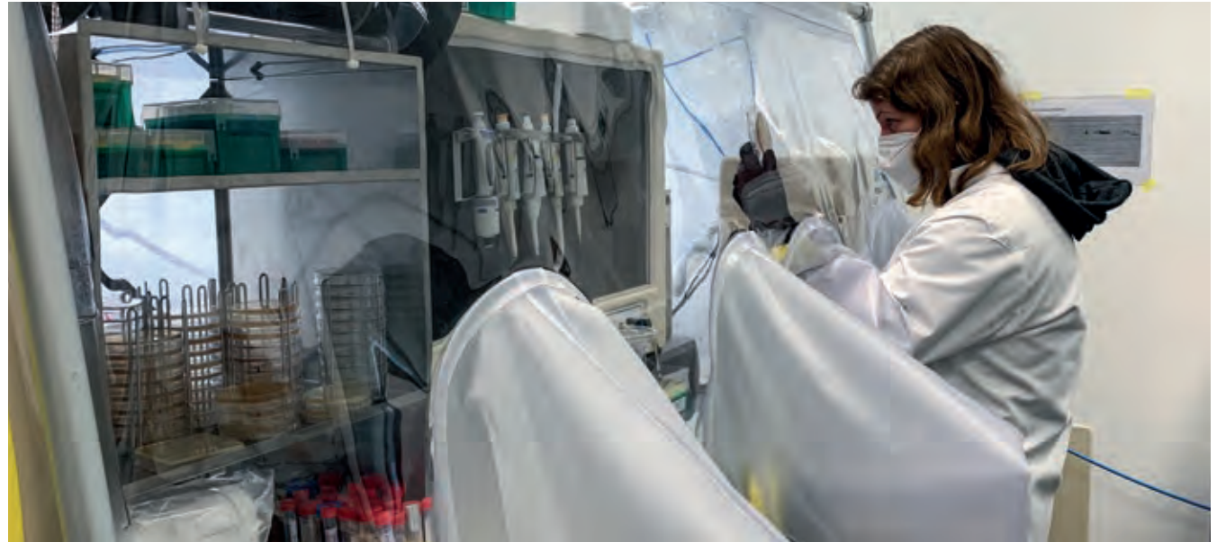
Das Arbeiten in einer anaeroben Kammer ermöglicht die Kultivierung von Sauerstoff-empfindlichen Bakterien in einer Sauerstoff-freien Atmosphäre.
